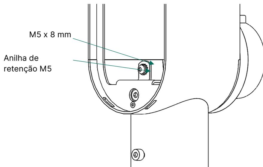
Fixar o cabo de ligação à terra na estrutura do Pole Mount com os parafusos M5 e a anilha de retenção M5.
