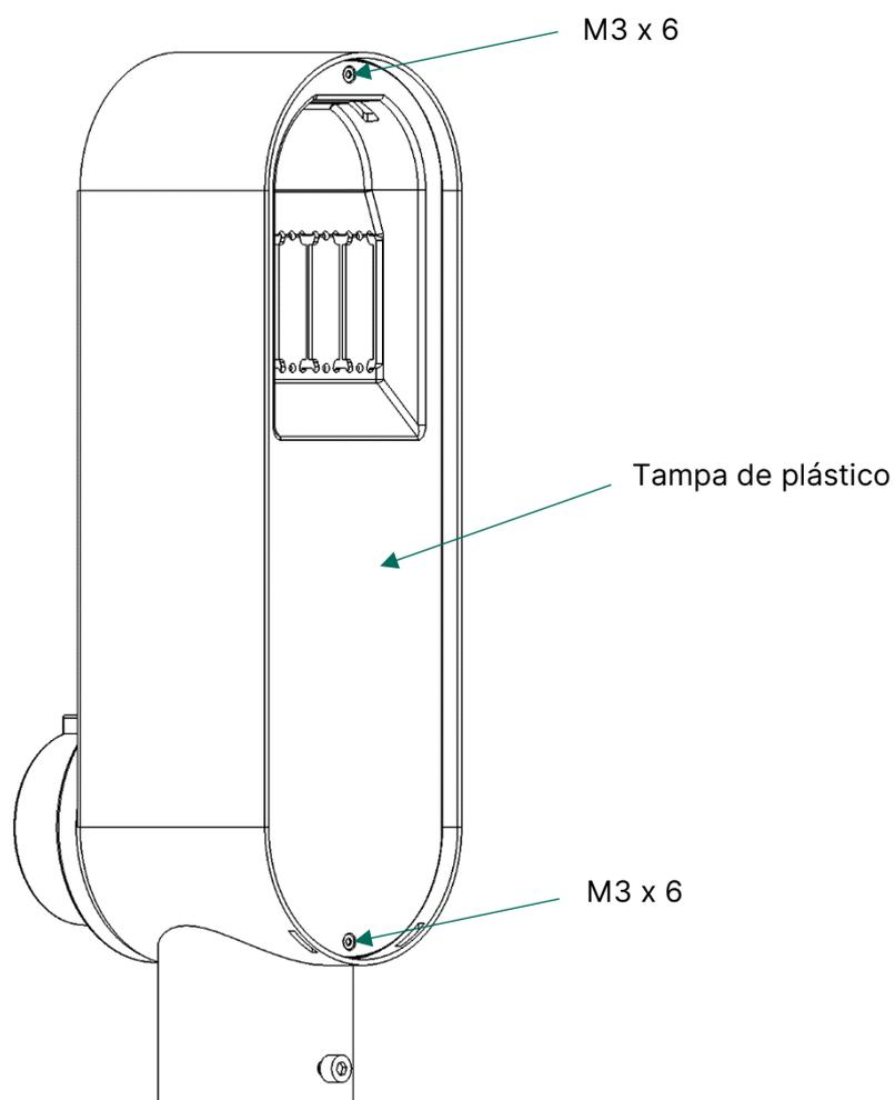
Desapertar os dois parafusos M3x6, remover a tampa de plástico e guardar.
