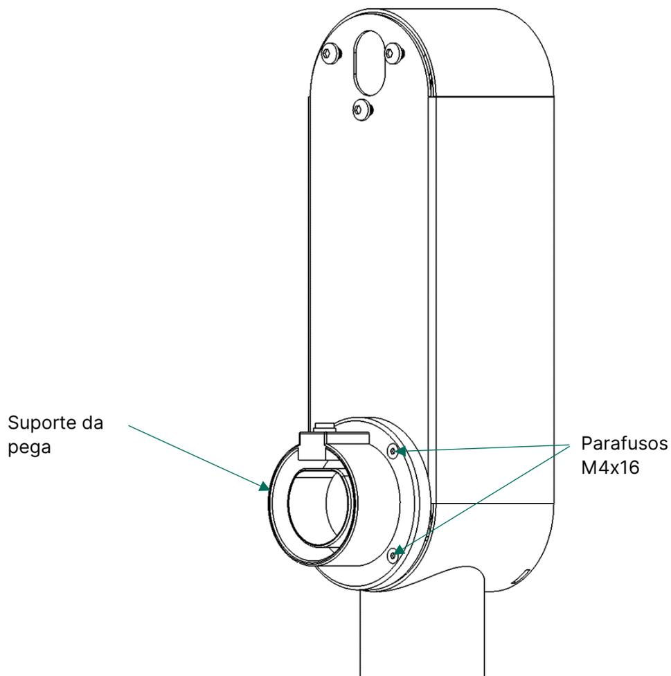
Montar o suporte da pega no Halo Pole Mount com os quatro parafusos M4x16 incluídos no *kit* de instalação.
