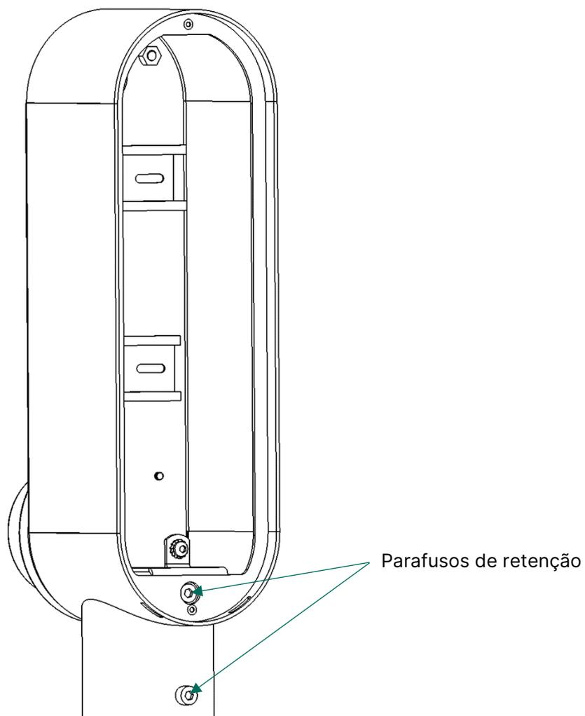
Colocar o Halo Pole Mount no poste e apertar os dois parafusos de retenção.
