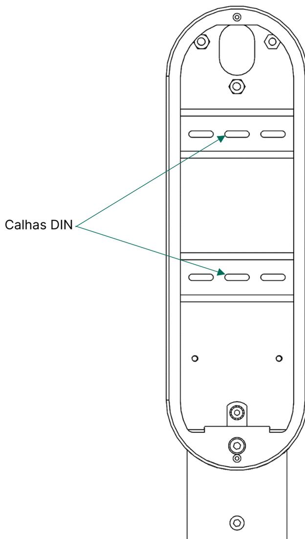
Existem duas calhas DIN pré-montadas para componentes adicionais, como, por exemplo, bloco de ligações, dispositivo diferencial e outros.
