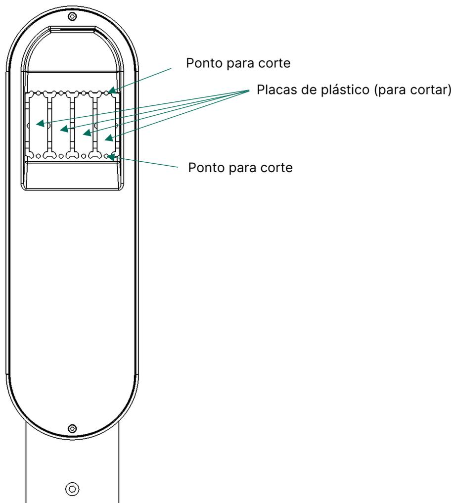
A tampa tem quatro placas de plástico que podem ser cortadas, caso seja usado um dispositivo diferencial. Medir a proteção e cortar as placas de plástico à largura do dispositivo diferencial. Cortar as placas depois de remover a tampa de plástico e guardar, conforme descrito abaixo.
