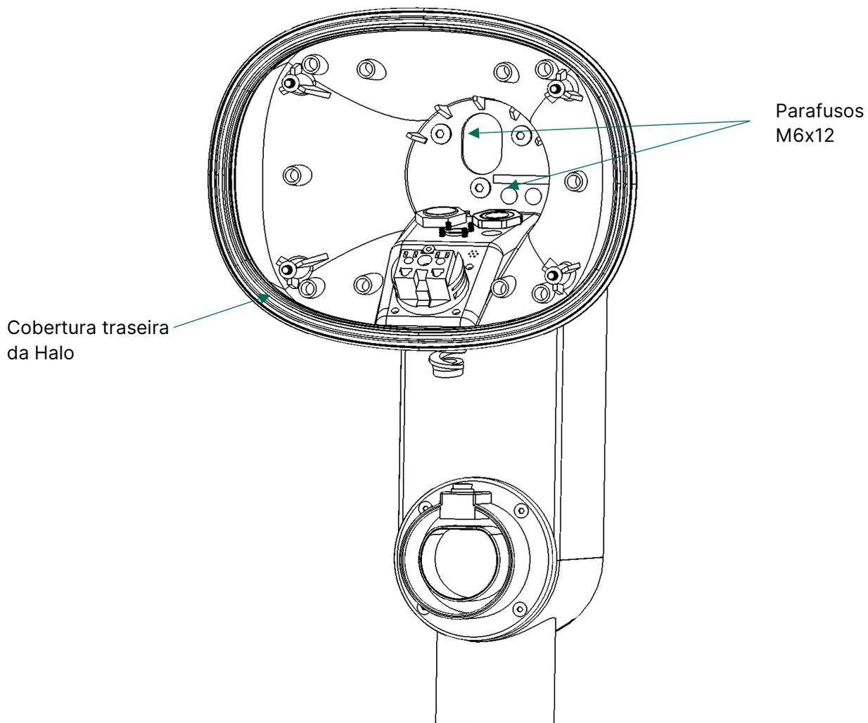
Usar os 3 parafusos M6x12 incluídos no *kit* de instalação para fixar a cobertura traseira no Halo Pole Mount. Lembre-se de colocar a junta de vedação incluída na embalagem da Halo entre a cobertura traseira da Halo e o Halo Pole Mount.
