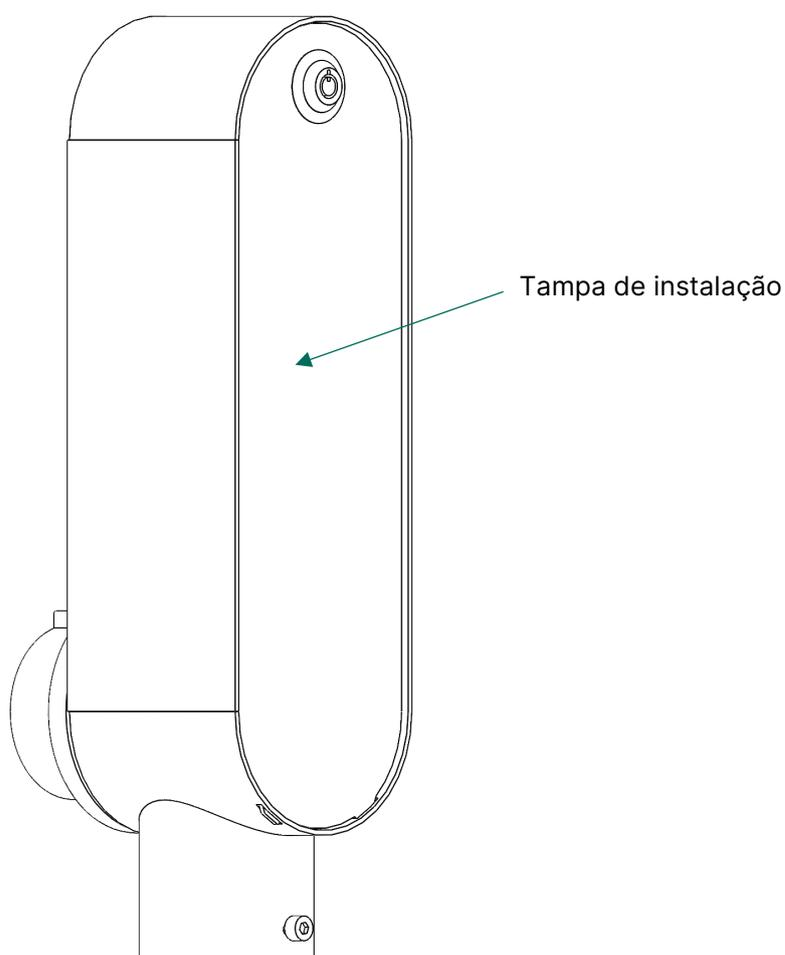
Abrir a tampa de instalação e remover.
