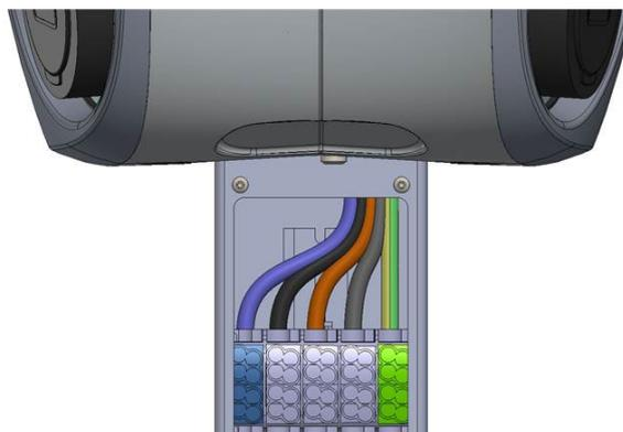
4. Cierre la tapa y asegúrese de que no haya ningún cable ni obstáculo en contacto con esta. Si hay algún cable presionando contra la tapa, no se obtendrá el grado de protección IP 44.
