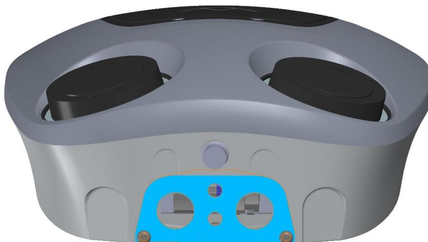
2. Inserte el primer punto de recarga Aura en el soporte para poste según se indica en la imagen siguiente.
