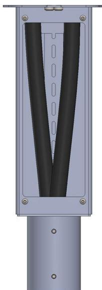
2. Cierre la tapa y asegúrese de que no haya ningún cable ni obstáculo en contacto con esta. Si hay algún cable presionando contra la tapa, no se obtendrá el grado de protección IP 44.
